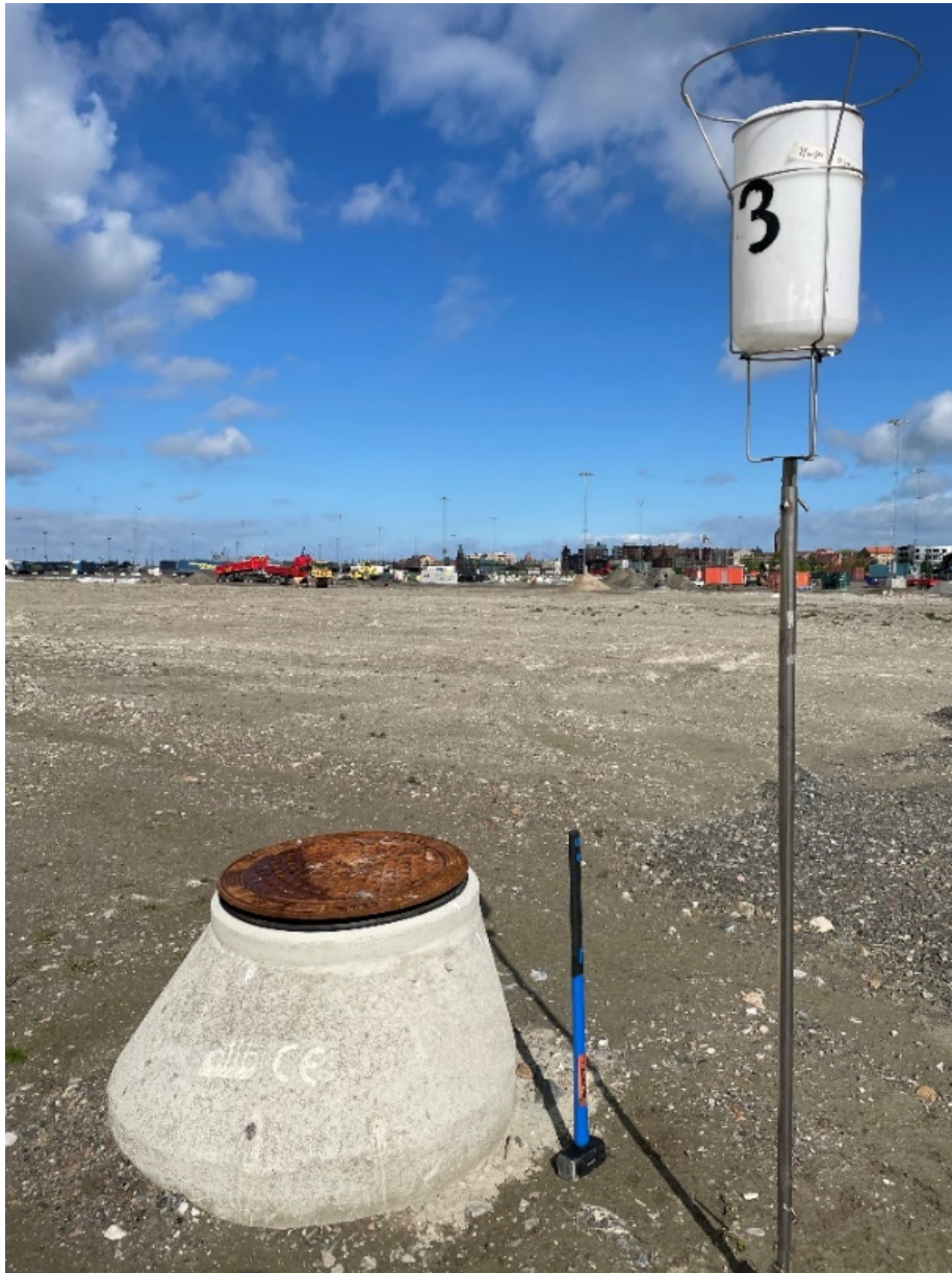
Figur 9 Nilu-tratt för mätning av deposition i Trelleborgs hamn (provtagningsspunkt 3, foto: Martijn van Praagh).
