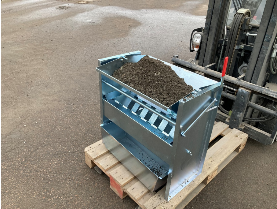
Figur 7 Neddelare (s.k. Splitter) för att ta fram analysprov ur samlingsprovet från slaggrus (Foto: Raul Grönholm).
