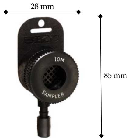
Figur 3 IOM-kassett för dammätning vid arbetsplatser som kan sättas på kavajslag ed., en pump ansluts underifrån (ALS Scandinavia AB, 2022).
