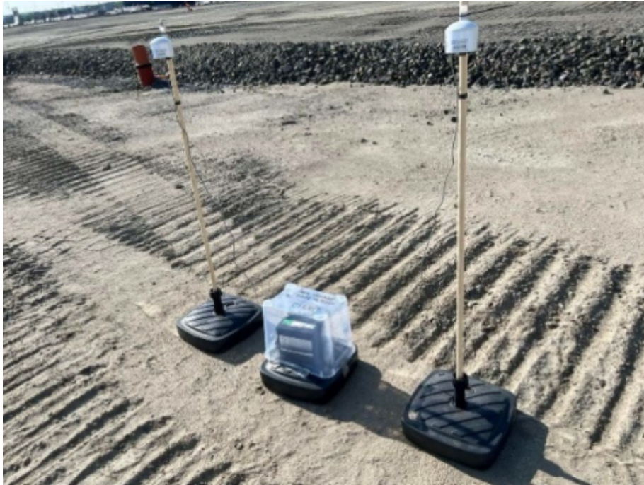
Figur 12. Rise mätstation med partikelsensorer på stavar och strömkälla i mitten (Foto: Adam Larsson)
