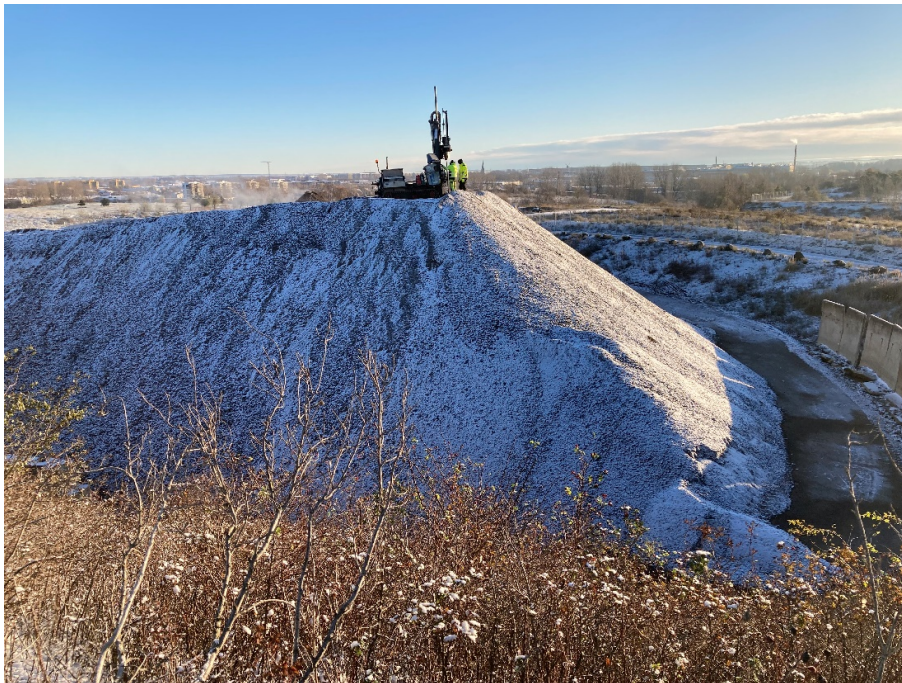
Figur 6 Slaggrus som provtas med borrhvagn ursprungligen avsedd för provtagning av jord (Foto: Raul Grönholm).
